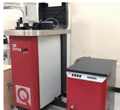
低温・高磁場で材料、半導体などの電気、磁気特性を測定
