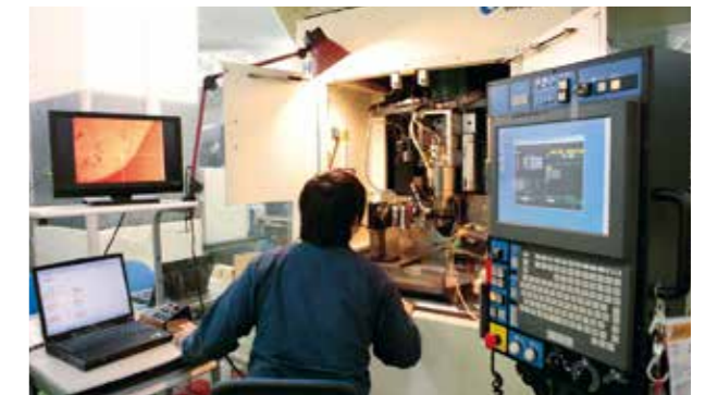
レーザー加工機でダイヤモンド工具を成形
