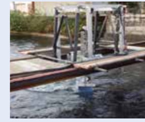
農業用水などでも発電可能なフラッタ水力発電システム
