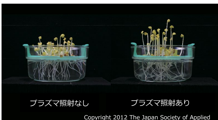
写真1：種子に30分間酸素プラズマ照射後、1週間栽培したカイワレ大根
