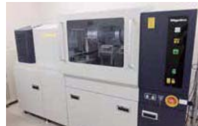
小角X線散乱測定装置
