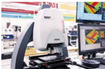
三次元光学プロファイラー(New View 9000)
