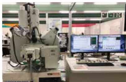
電子プローブマイクロアナライザー(EPMA) (平成30年度 文部科学省・私立学校施設整備費 補助金採択)
