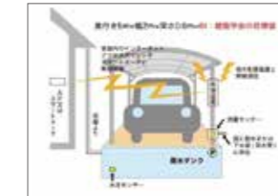
各家庭にスマート雨水タンクを設置、浸水予測のスマートフォン通知システム考案
