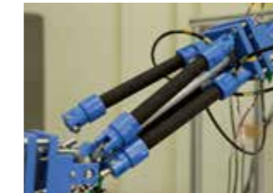
医療現場で活躍する人工筋肉の遠隔操縦ロボットアームを開発
